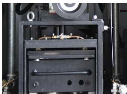
真空式送平台 只针对工件边角，孔边缘，表面影响很小
